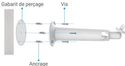
**i** Lors du perçement de trous pour les boulons expansibles, s'assurer que le diamètre de la tête de forage est compris entre 5,5 mm et 6 mm et que la profondeur du trou n'est pas inférieure à 25 mm.
